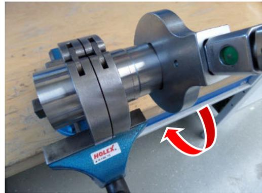
20. Spiral-Sicherungsring (29), an der Entfernungskerbe mit der flachen Spitze eines kleinen Schraubendrehers, aus der innenliegenden Nut des Anschlussdeckels (01) hebeln.
