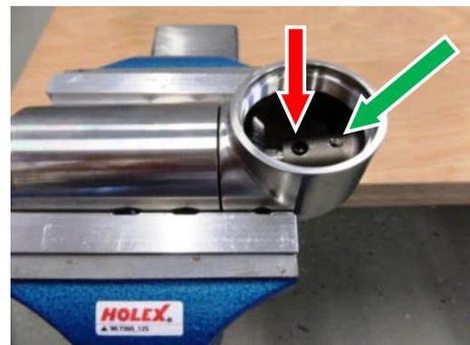
9. Gewindestift (34) durch einen leichten Körnerschlag im Bereich des vorderen Gewindeganges am Dom der Welle-Achs-Verbindung (24) gegen Verlieren sichern.
