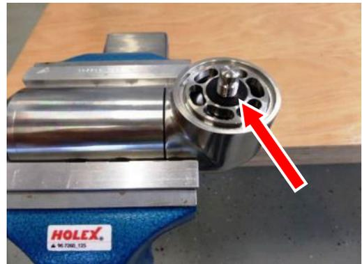
8. Spiral-Sicherungsring (30) vor dem Lagerschildes (28), an der Entfernungskerbe mit der flachen Spitze eines kleinen Schraubendrehers, aus der innenliegenden Nut der Welle-Achs-Verbindung (24) hebeln und spiralförmig herausdrehen.
