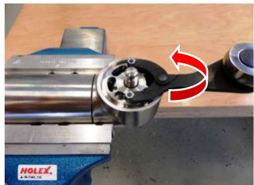
10. Mitnehmerwelle (25) zusammen mit Lagerschild (28); Bundbuchse (08); Zylinderstift (35), Kegelrad f. Düsenträger (26) und Spiral-Sicherungsring (31) aus der Welle-Achs-Verbindung (24) nehmen.
