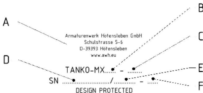
Abbildung 2.5-1: Position Typenschild
