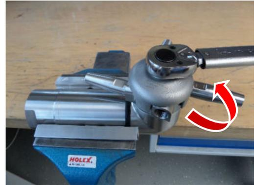
6. Bundbuchse (07) des Düsenträgers (27) entfernen.
