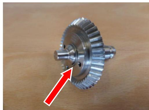
12. Zapfen der Mitnehmerwelle (25) zusammen mit Zylinderstift (35); Kegelrad f. Düsenträger (26) und Spiral-Sicherungsring (31) in die Buchse (09) der Welle-Achs-Verbindung (24) schieben.
