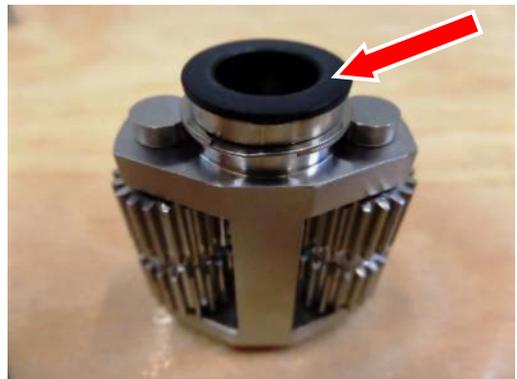
11. Spiral-Sicherungsring (32), an der Entfernungskerbe mit der flachen Spitze eines kleinen Schraubendrehers, aus der außenliegenden Nut des Planetenträgers (16) hebeln und spiralförmig abdrehen.
