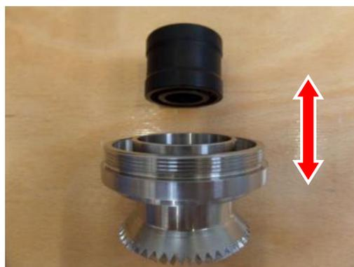
7. Stirnrad (22) mit Bundbuchse (05) aus dem Gehäuse (02) nehmen.
