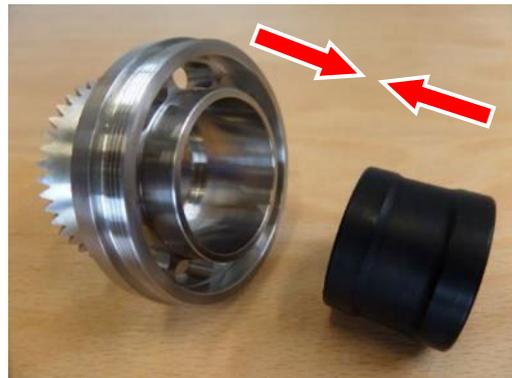
20. Kegelrad f. Gehäuse (23) mit dem Gleitlager (10) auf die Welle des Stirnrades (22) schieben.
