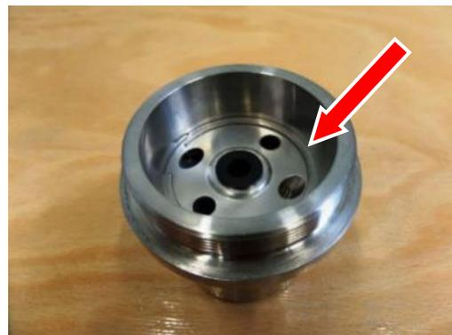
4. **HINWEIS** Durch falsches Einspannen in den Schraubstock können Gewindeverbindungen unbeabsichtigt geklemmt und verformt werden!
