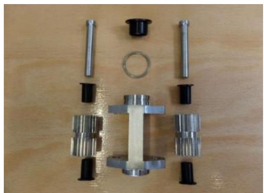
14. Stirnrad (18) zusammen mit Flügelrad (15) und Gewindestift (33) aus dem Gehäuse (02) nehmen.
