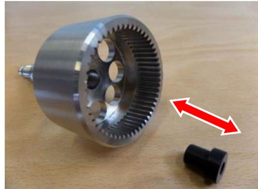
9. Planetenträger (16) komplett mit Stirnrad (19; 20); Achse f. Planetenrad (17); Spiral-Sicherungsring (32) und Bundbuchse (03 und 04) aus dem Gehäuse (02) nehmen.
