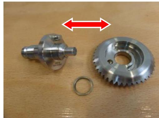
16. Buchse (09) mit einer spitzen Zange aus der Welle-Achs-Verbindung (24) ziehen oder mit der flachen Spitze eines kleinen Schraubendrehers heraushebeln.
