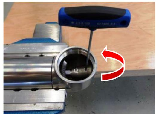
18. Das Gerät mit einer Hand festhalten und Schraubstock lösen.
