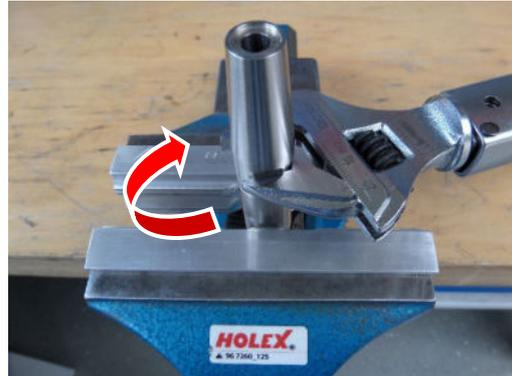
2. Welle-Achs-Verbindung (24) in dem Schraubstock so einspannen, dass der Dom nach oben und das Gewinde für das Lagerschild (28) zur Seite zeigen.
