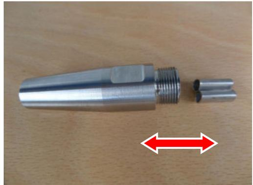
25. Dichtring (13.3) aus der Gewindebohrung des Düsenträgers (27) bzw. aus der Düsenverlängerung (12.1) entfernen (z. B. mit O-Ring Pick).
