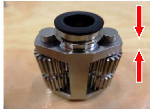
16. **HINWEIS** Durch falsches montieren des Planetengetriebes können die Zahnräder ineinander klemmen!
