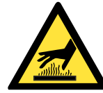
Warnung vor heißer Oberfläche
