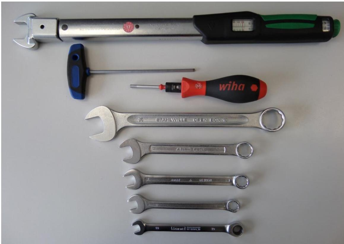
Abbildung 7.4-2 notwendiges Werkzeug für TANKO-RTP/ -RTPS
