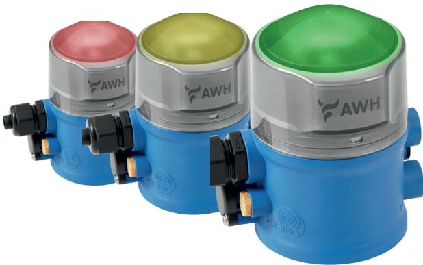
Im Sockel ist ein **weiterer pneumatischer Anschluss**, mit dem unter anderem Spülventile der Leckageventile angesteuert werden können. Die innere Luftführung sorgt dafür, dass zwischen pneumatischem Antrieb und Steuerkopf **keine äußeren Luftleitungen sichtbar** sind.
