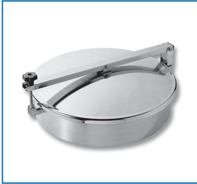
Der Deckeltyp P31 ist für drucklose Behälter ausgelegt worden. Er findet seine Anwendung hauptsächlich als Domdeckel auf dem Tank, dabei muss das Flüssigkeitsniveau unterhalb des Tankdeckels liegen. Die Konstruktion ermöglicht eine einfache Bedienung zum Öffnen und Schließen ohne Werkzeug.
