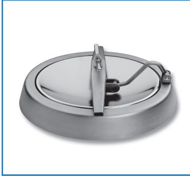
Der Deckeltyp P11 wird hauptsächlich in Lagertanks eingebaut. Er dient dabei als Zugang für Wartung und Reparatur. Durch die konische Zargenform kann der Tankdeckel einfach am Tank angepasst werden. Weiterhin wird durch die Zargenhöhe die Krümmung des Tanks ausgeglichen.
