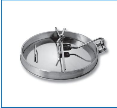
Der Deckeltyp P11 wird hauptsächlich in Lagertanks eingebaut. Er dient dabei als Zugang für Wartung und Reparatur. Weiterhin wird durch die Zargenhöhe die Krümmung des Tanks ausgeglichen. Die häufigste Einbaulage ist seitlich im unteren Bereich, die eine sichere und einfache Begehung ermöglicht.
