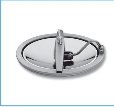
Der Deckeltyp P11 wird hauptsächlich in Lagertanks mit ebenen Flächen eingebaut. Er dient dabei als Zugang für Wartung und Reparatur. Durch die flache Zargenform wird ein Dom vermieden. Weiterhin wird durch die flache Zargenhöhe eine gute Reinigung erreicht.
