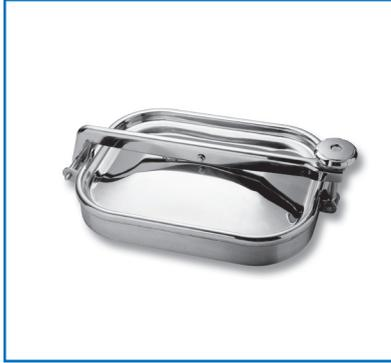
Der Deckeltyp P23 ist für drucklose Behälter ausgelegt worden. Er findet seine Anwendung hauptsächlich als Inspektionsluke an Maschinen (z.B. Waschmaschine). Der Deckel darf im Spritzbereich über und unter dem Wasserspiegel (max. 3 m Wassersäule) eingesetzt werden.
